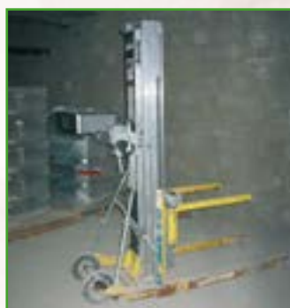
Wagen mit höhenverstellbarer Gabel
