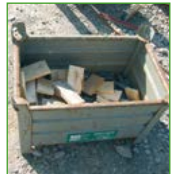
Metallcontainer zur Aufbewahrung von Zubehör, mit dem Kran transportierbar
