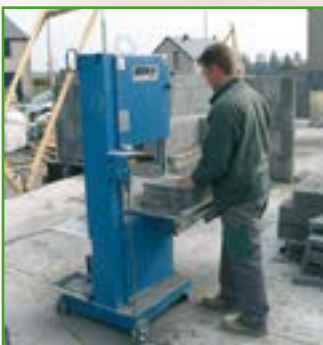
Maschinen statt Handwerkzeugen für eine bequemere Körperhaltung
