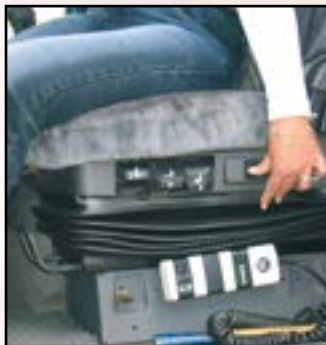
Sitz mit pneumatischer Federung
