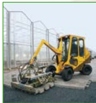
Bordsteingreifer an Baustell- Maschine mit Vakuumgreifer lenfahrzeug zum Befördern zum Verlegen vieler Pflaster- schwerer Lasten steine auf einmal
