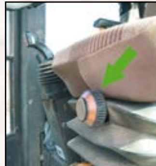
Verschiedene Sitzeinstellmechanismen für das Körpergewicht des Fahrers
