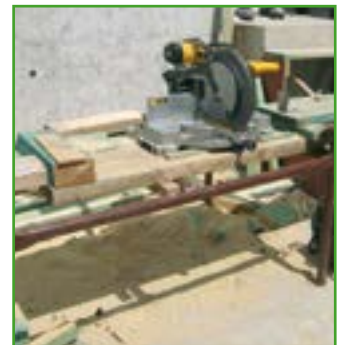
Auf einer Werkbank montierte tragbare Säge erspart das Bücken
