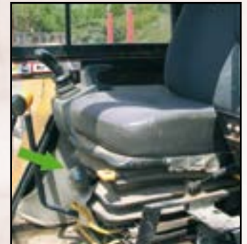
Verschiedene Sitzeinstellmechanismen für das Körpergewicht des Fahrers
