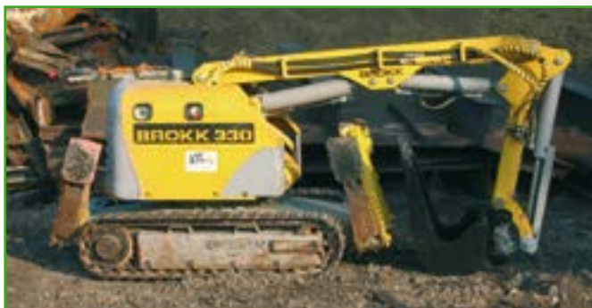
Roboter für die Asbestentfernung bei Cowpern
