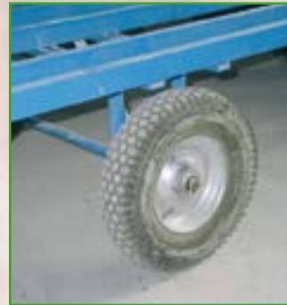
Große Räder sind auf unebenem Gelände leichter zu manövrieren
