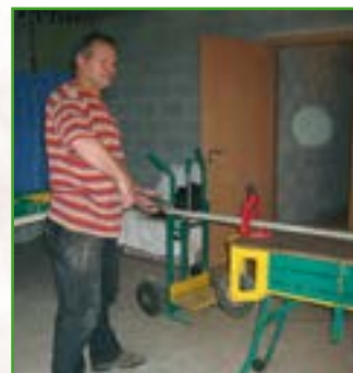
Mobile (Klapp-)Werkbank mit Rollen und Schubfächern
