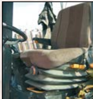
Sitz mit mechanischer Federung
