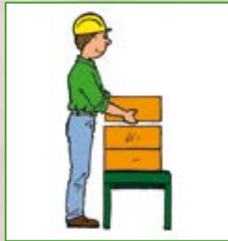
Rückenschonend: Abstellen von Lasten auf einer Ablage
